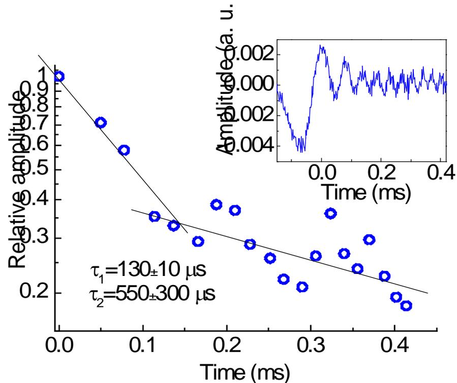
**Equivalent Q ~  $3 \times 10^{11}$ ;  $\Delta f = 660 \text{ Hz}$ !**
